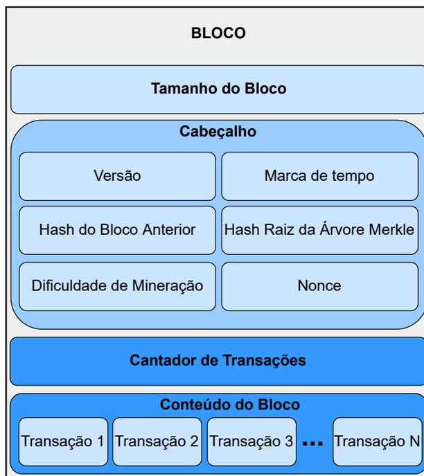
Figura 3.4. Estrutura dos blocos da Blockchain Bitcoin
